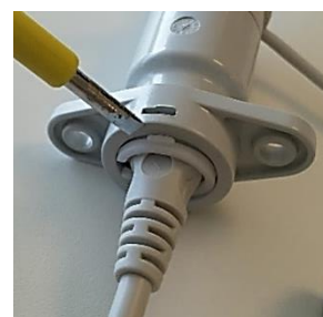
Afmontering af kabellås ved hjælp af flad skruetrækker
