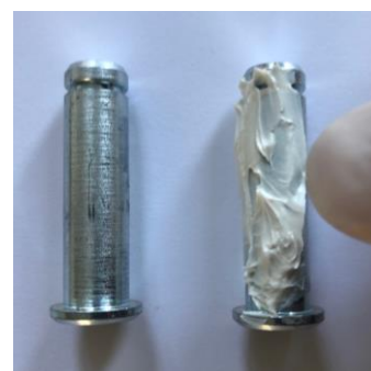
Påføring af fedt på bolt
