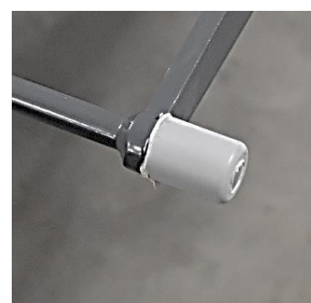
Påsat nylonhjul på smurt aksel
