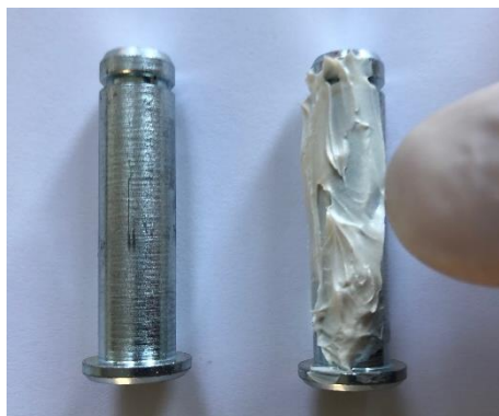
Påføring af fedt på bolt
