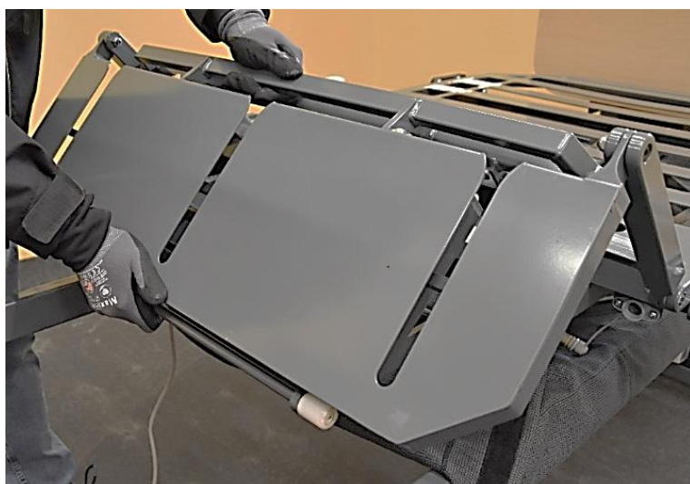
Bendelens nylonhjul løftes ud af u-profilen
